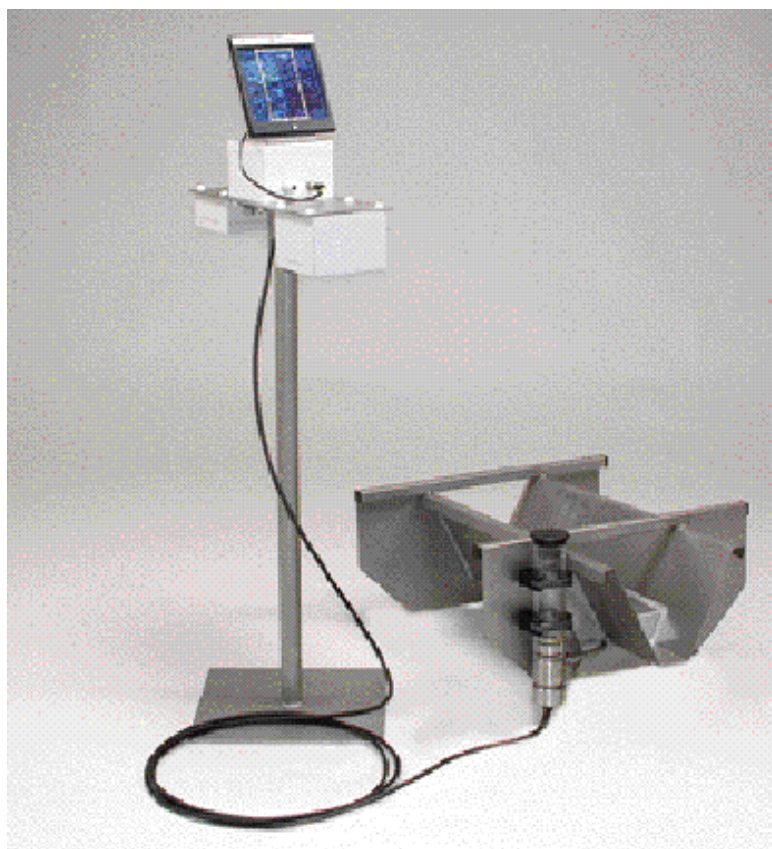
Mali RBC žleb sa pretvaračem pritiska, procesorom i solarnim panelom
